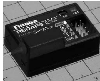
Empfänger R 604 FS 2,4 GHz, 4-Kanal FM/HRS-FSK-Empfänger
