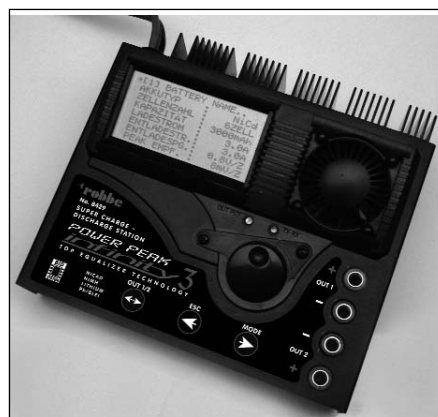
Power Peak Infinity 3 No. 8429 Die intelligente und ultimative Heim - Ladestation mit komfortablem Akkumanagement, zum Laden und Entladen von NC-, NiMH-, Blei und Lithium-Akkus. Zellenzahl NC - Akkus: 1...30 Zellen, NiMH - Akkus: 1...30 Zellen Blei - Akkus: 1...6 Zellen Lithium - Akkus: 1...12 Zellen Lade- Entladestrom 0,1..10 A
